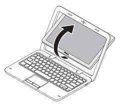
**2.** 轻推显示屏面板的上部并将其顺时针旋转 180 度。
